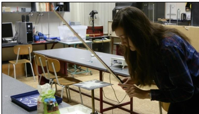
Obrázek č. 12 - pokus č. 1 - Chladního obrazce se smyčcem
